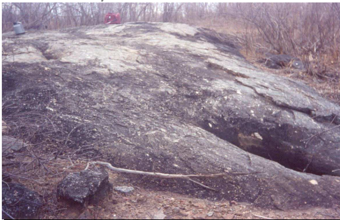
Foto N° 02 – Grande afloramento de gnaiss migmatítico na ombreira direita, no eixo, entre as estacas 23 a 25.
